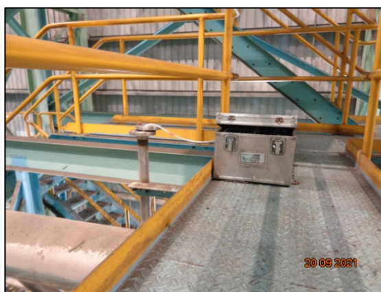
รูปที่ 3.9 การเก็บตัวอย่างคุณภาพอากาศในปล่องระบาย บริเวณ Alkali Cleaning Stack MCL1 (S3) (ในเดือนกันยายน 2564)
