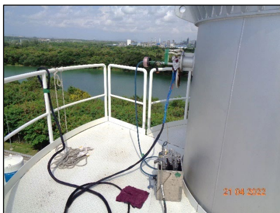
รูปที่ 3.15 การเก็บตัวอย่างคุณภาพอากาศในปล่องระบาย บริเวณ Furnace Stack MCL 3 (S16)
