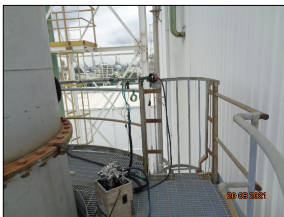
รูปที่ 3.1 การเก็บตัวอย่างคุณภาพอากาศในปล่องระบาย บริเวณ Furnace Stack MCL1 (S4) (ในเดือนกันยายน 2564)
