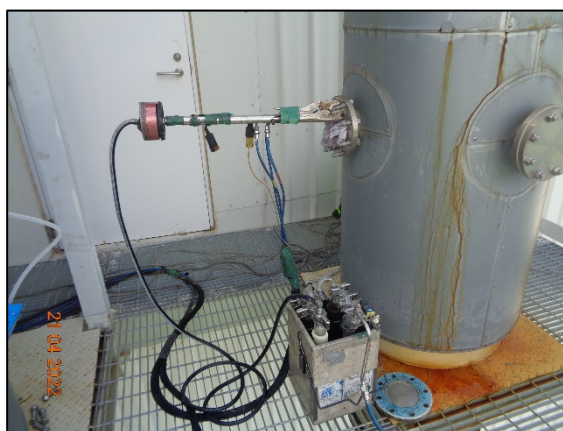
รูปที่ 3.16 การเก็บตัวอย่างคุณภาพอากาศในปล่องระบาย บริเวณ Oven Stack MCL 3 (S17)
