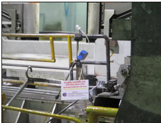
รูปที่ 3.29 การตรวจวัดคุณภาพอากาศในพื้นที่ทำงาน บริเวณ Passivation ในสายการผลิต Zincalume Line MCL1 (เดือนกันยายน 2564)
