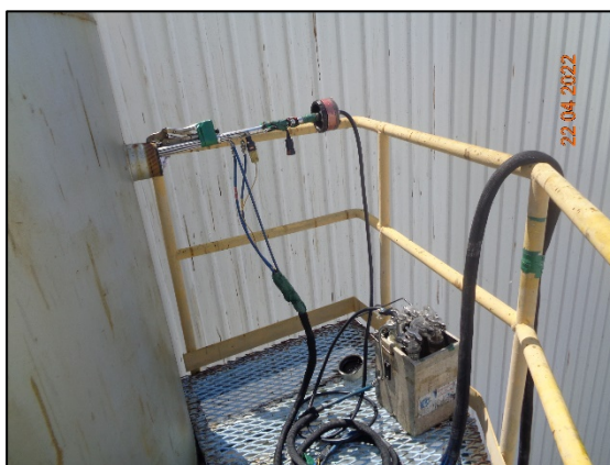
รูปที่ 3.8 การเก็บตัวอย่างคุณภาพอากาศในปล่องระบาย บริเวณ Cold Mill Stack CRM (S2)
