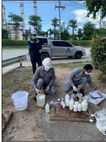
รูปที่ 3.24 การเก็บตัวอย่างคุณภาพน้ำทิ้ง บริเวณบ่อน้ำทิ้งหลังผ่านระบบบำบัดน้ำเสียของโครงการ (Ww)
