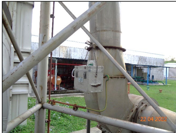
รูปที่ 3.12 การเก็บตัวอย่างคุณภาพอากาศในปล่องระบาย บริเวณ Alkali Cleaning Stack CPL (S11)
