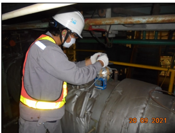
รูปที่ 3.5 การเก็บตัวอย่างคุณภาพอากาศในปล่องระบาย บริเวณ Inline Painting Stack MCL1 (S6) (ในเดือนกันยายน 2564)
