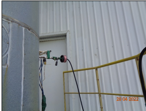
รูปที่ 3.11 การเก็บตัวอย่างคุณภาพอากาศในปล่องระบาย บริเวณ Passivation & Resin Combine Stack MCL2 (S9)
